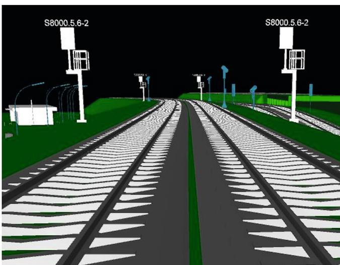
**Bild 3: Mit LST2BIM erzeugte Signal-Dummies**
