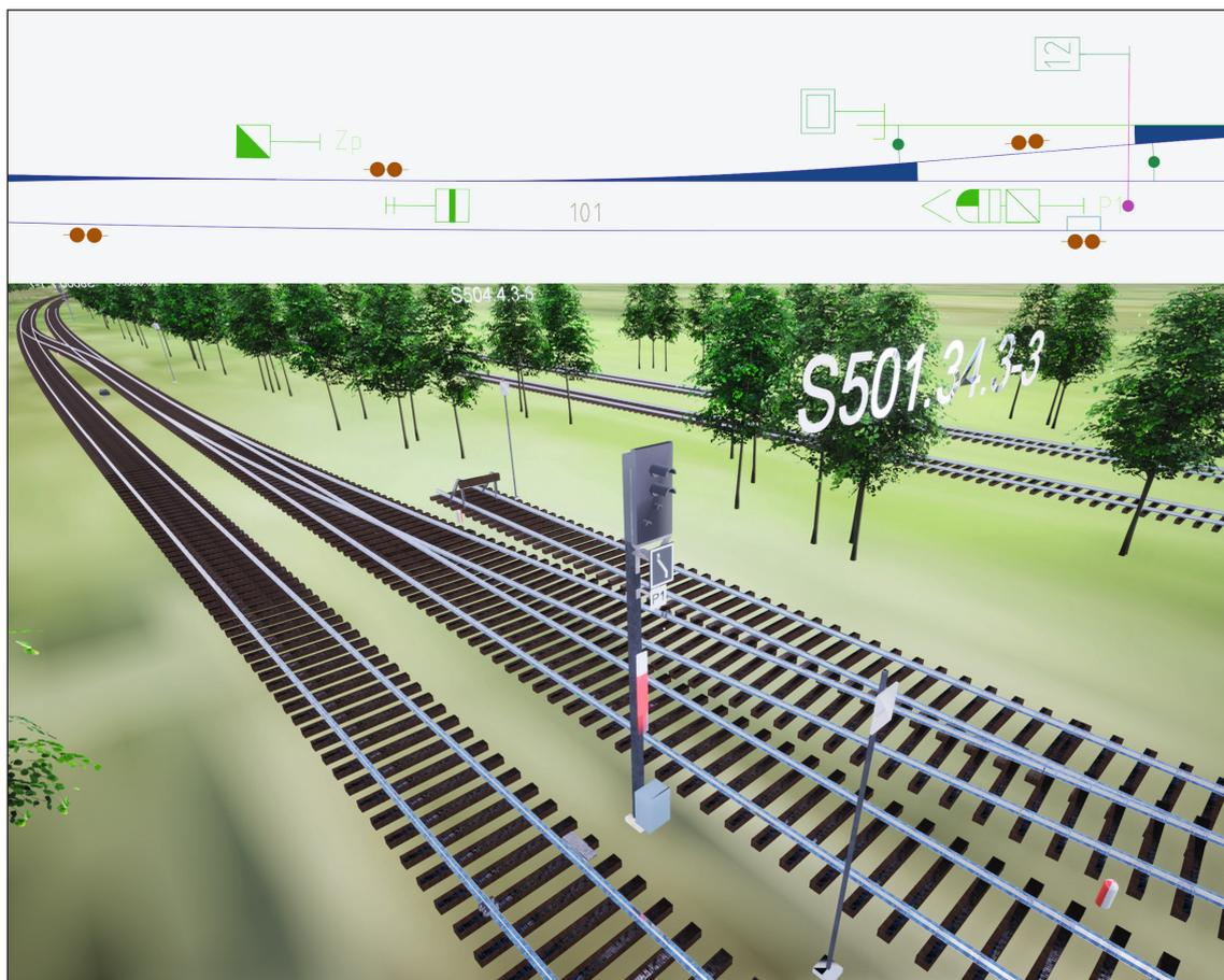
In einem ersten Testprojekt im Rahmen der o. g. BIM-Pilotprojekte wurden die Signale des Abzweigs Gutleuthof im Knoten Frankfurt am Main in einen 3D-Raum eingefügt, in dem bereits Bestandsobjekte enthalten waren (Bild 3).
