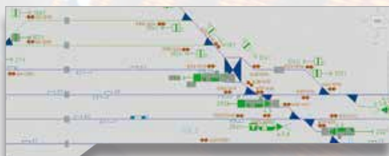
Bild 7: Ausschnitt eines Sicherungstechnischen Übersichtsplans in ProSig.
