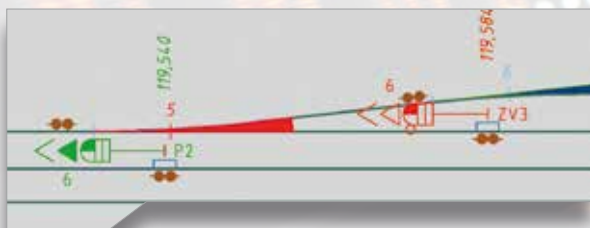
Bild 10: Signal ZV3 wurde automatisch als Flankenschutz für die Weiche 5 in Linkslage ermittelt.
